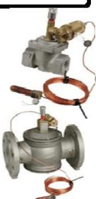
Valvola intercettazione per metano, GPL, gasolio, olio combustibile, ad azione positiva a riarmo manuale corpo e interni in ottone - bulbo in rame, tenuta NBR lunghezza capillare 6 mt.
