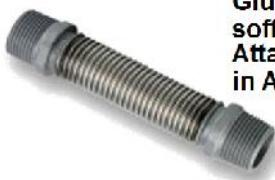
Giunto adatto per gas con soffietto multiparete in AISI Attacchi filettati maschio verniciati in Acciaio A 105 Temp. di esercizio:-55°C+250°C
